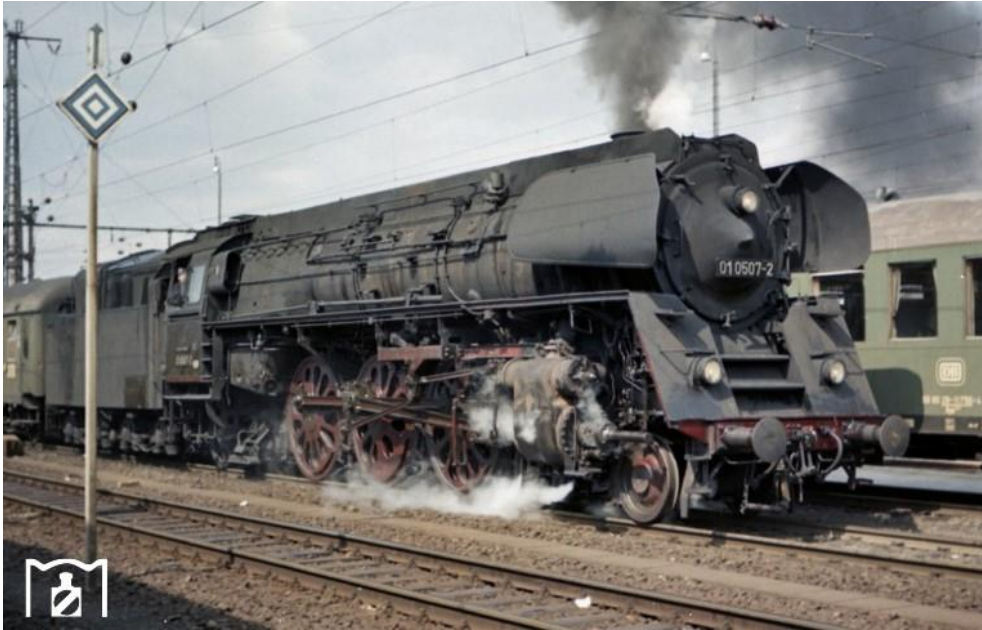
01 0507 (Bw Erfurt) mit Boxpok-Radsätzen und - als einzige Lok ihrer Baureihe - mit Scheibenradsatz im Vorlaufdrehgestell im Bahnhof Bebra. (08.1972) Foto: Fritz Eisenhuth / Eisenbahnstiftung*
